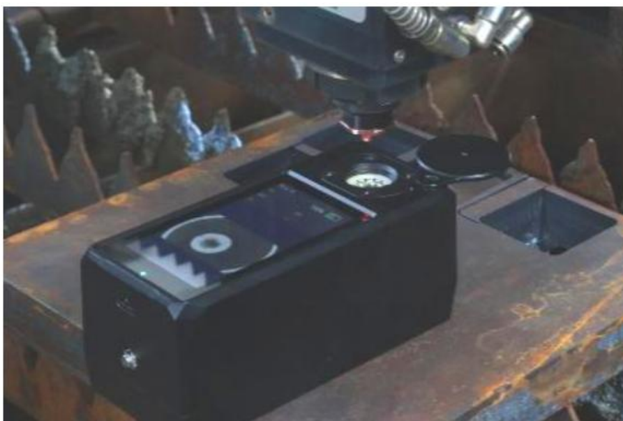
Рисунок 4-4. Крышка окна распознавания открыта
