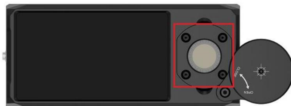
Рисунок 5-2. Снимите пластину из токопроводящего стекла
